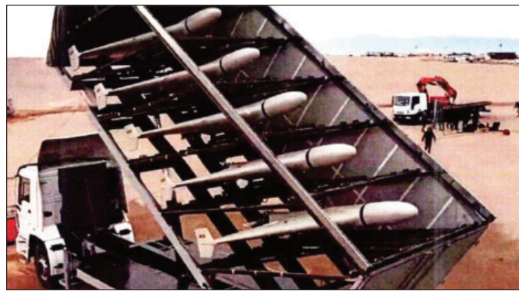
Пускова установка БПЛА «Shahed-136», замаскована під самокід.
